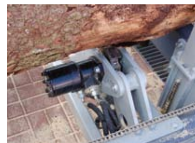
Nowością w tej maszynie jest również to, że hydraulika nie jest spawana do korpusu, ale przykręcana. Jeśli zachodzi potrzeba zmiany jej układu, nie trzeba ingerować w konstrukcję maszyny.
