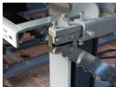
Zamiast klasycznych rolek, zastosowano specjalne, dwustronne, chłodzone cieczą ślizgi. W praktyce maszyna ta pracuje ciszej niż trak z piłami o szerokości 35 mm.
